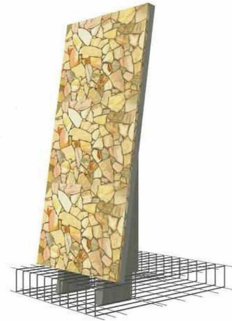
muro costolato rivestito.jpg
